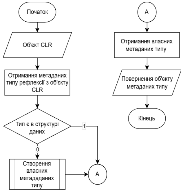
Рис. 4. Блок-схема алгоритму процесу отримання метаданих властивостей типу даних
